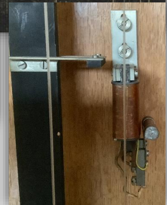
Elettromagnete di sincronizzazione dell'orologio di riserva
