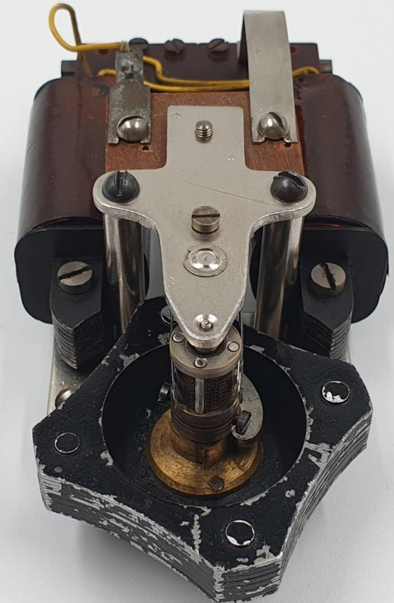
Motore revisionato con rotore e mollette di contatto sostituite
