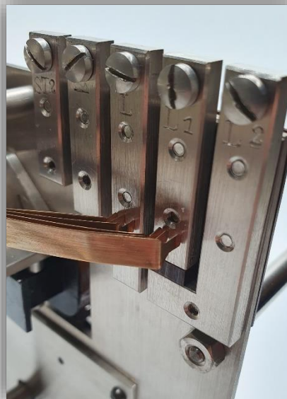
Dettaglio dei contatti a lama
