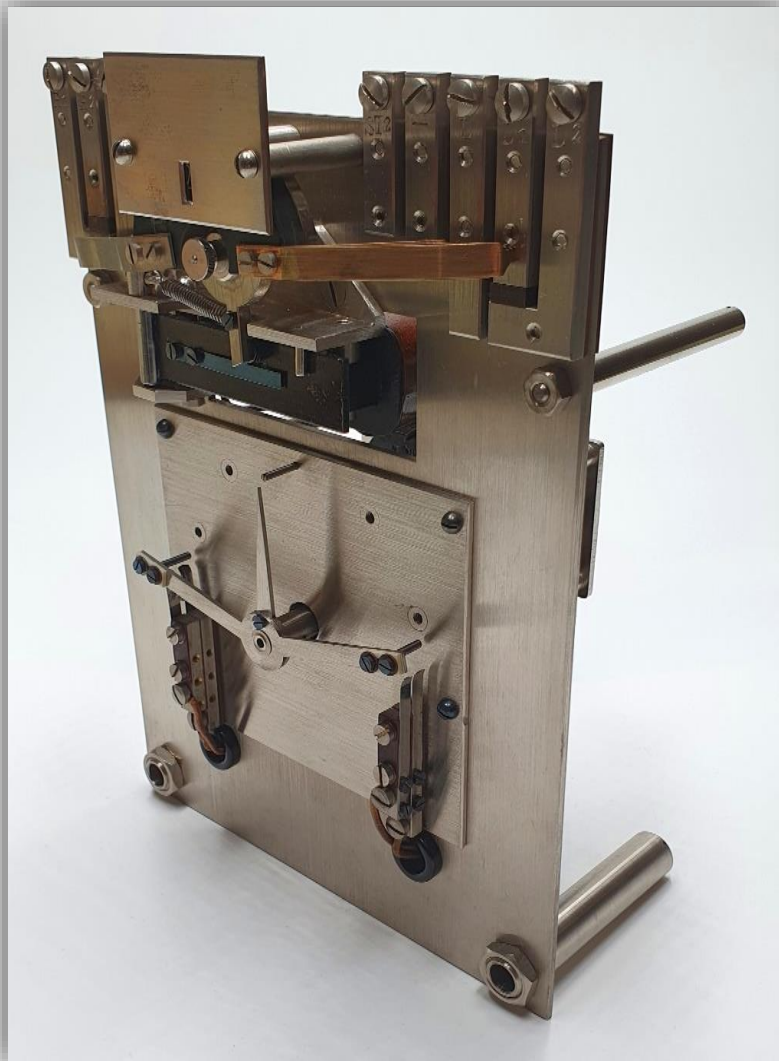
Dettaglio dei contatti a lama
