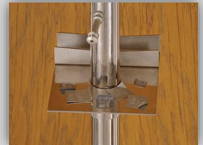
Supporto per l'appoggio dei pesi per la regolazione fine
