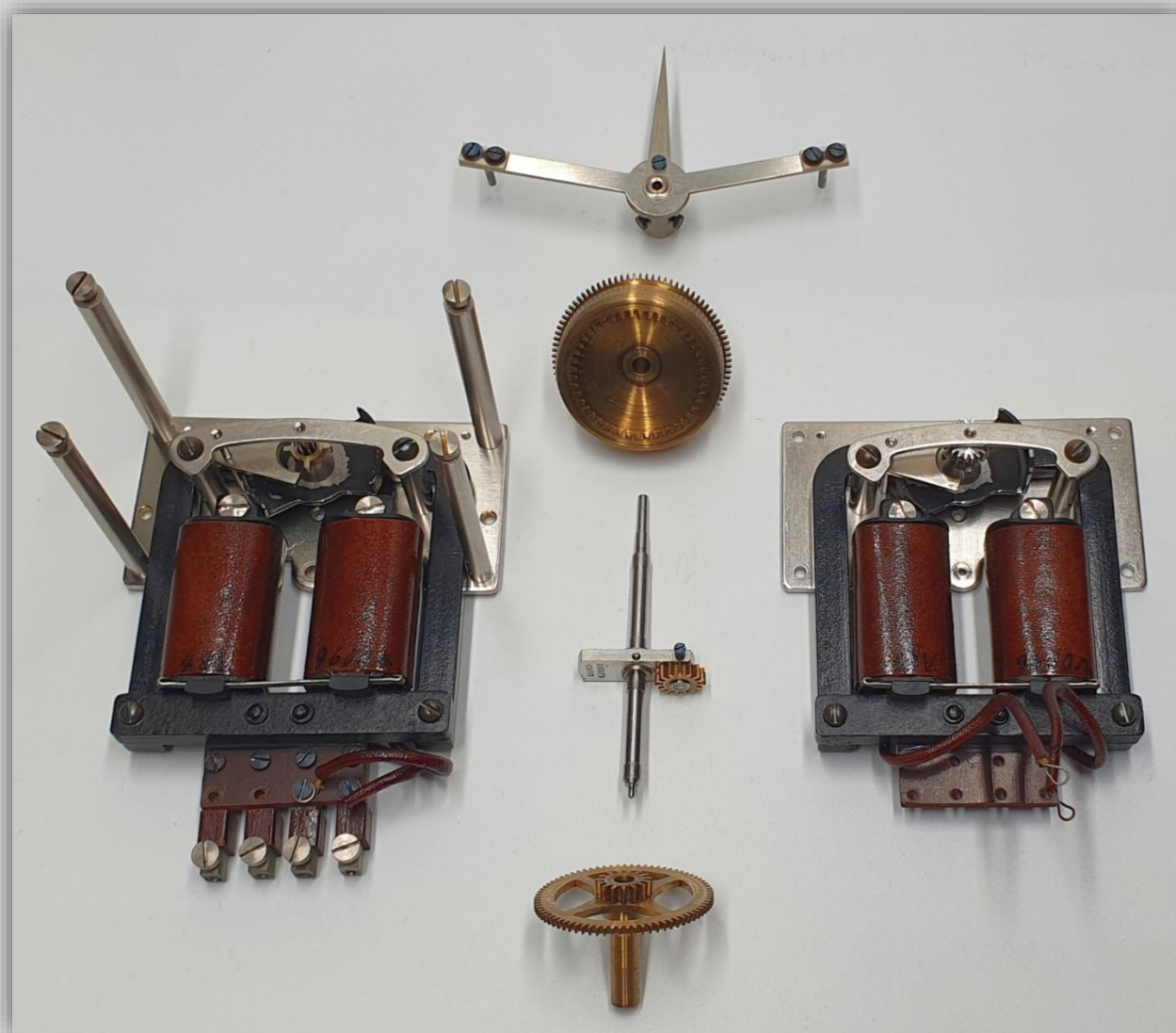
Vista esplosa del movimento differenziale
