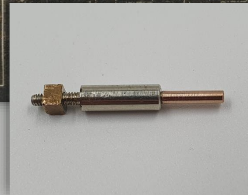
Perno del contatto con inserto ricostruito in bronzo fosforoso
