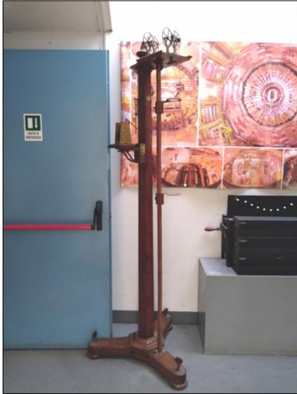
“Eccellente Barometro a pozzetto mobile con doppia graduazione, Inglese e Francese, in tavoletta metallica, con un nonio per ciascuna graduazione, e con incassatura di radice di noce.”
