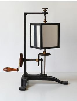
Apparato per il confronto delle vibrazioni di due colonne sonore d'aria
